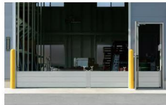
設置時間は一人で約10分程度 （高さ約50cm、幅約5mの開口部にウォーターシャッターを取り付ける場合）
